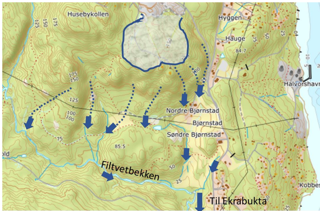
Figur III: Bekkefar og illustrasjon av tilsigsløp av overvann og vann gjennom bergsprekker til Filtvetbekken.
