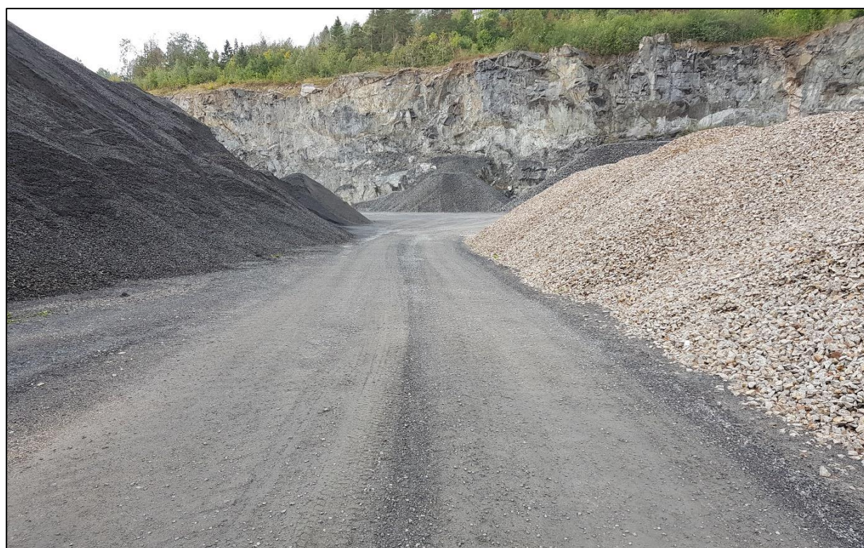
Figur 1-4: Bildet viser forskjellen mellom den svarte grovkornete gabbroen (råstoff til isolasjon) og den lysere granittiske gneisen/migmatitten (byggeråstoff).
